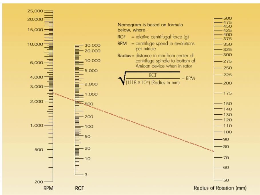
در این حالت با کشیدن خطی که از شعاع سانتریفوژ و g مورد انتظار عبور می کند و ادامه آن، سرعت بدست می آید. بعنوان مثال در شکل فوق برای بدست آوردن قدرت 500g در سانتریفوژی که شعاع آن ۷۵ میلی متر است، لازم است سرعت روی ۲۵۰۰ دور در دقیقه تنظیم گردد.
