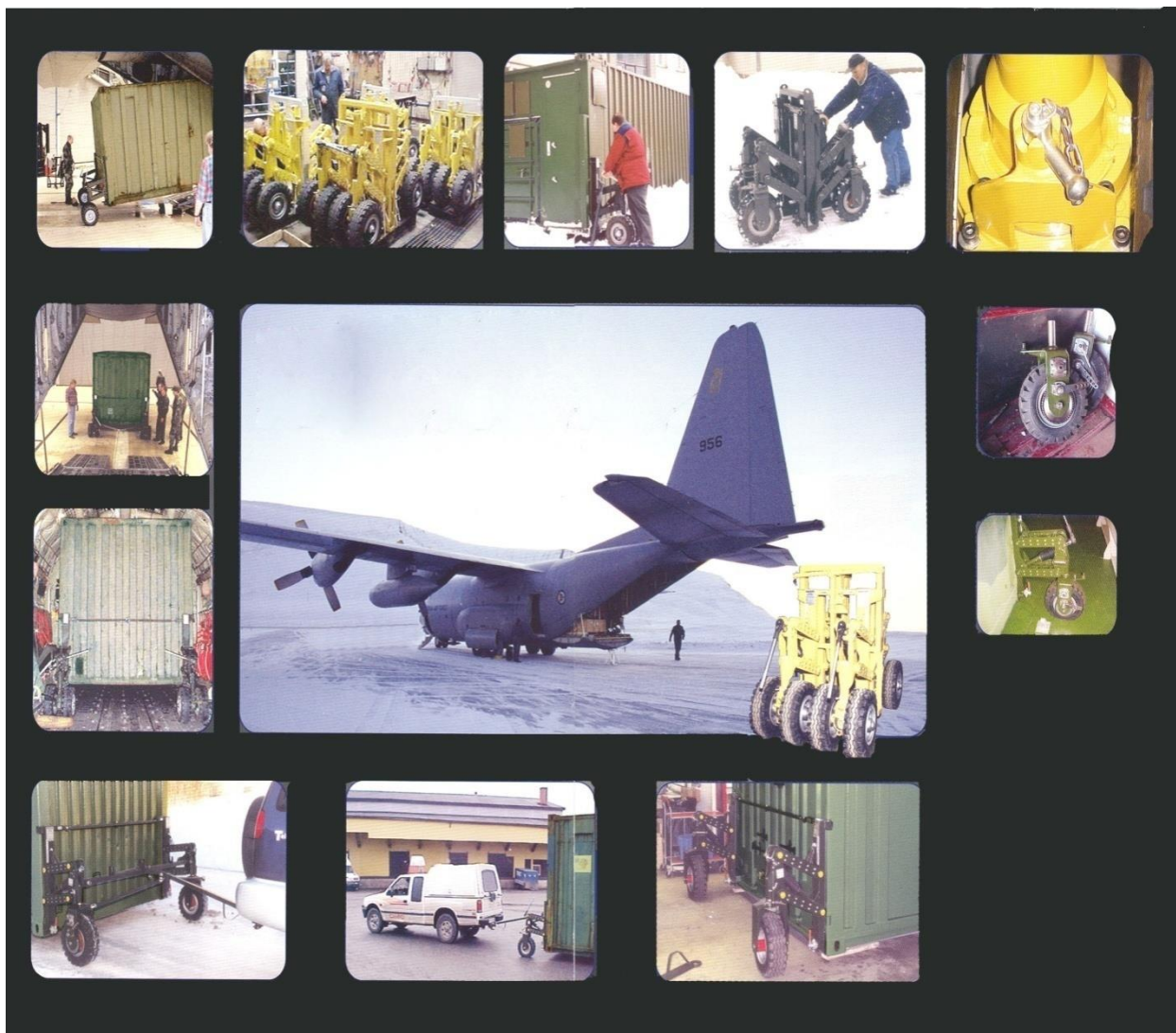
شکل ۲۵-۴ استفاده از دستگاه‌های (Power pack) و (wing lifter)، این وسایل شرایطی فراهم می‌آورند که پس از اتصال به کانتینرها، این کانتینرها به راحتی توسط Power pack پیاده شده و یا توسط wing lifter حتی با سرعت ۳۰ کیلومتر در ساعت روی جاده انتقال یابند.
